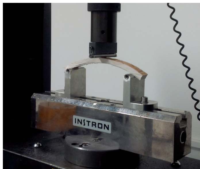
Fig.8: Esempio di test a tre punti come richiesto dalla UNI 11681 per l'acquisizione del dato di modulo elastico del liner in progetto, e per la verifica a fine lavori della conformità del liner posato ai dati di progetto
